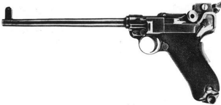
unter dem Mittelpunkt des Hülsengewindes. Dieser Prototyp benützt den originalen Schlagbolzen, der Auszieher wurde geändert. (aus „Luger Variations“ von Harry E. Jones)
