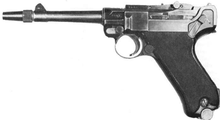
Das ERMA WECHSELSYSTEM montiert auf die Pistole 08
