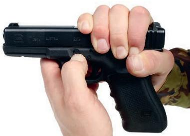
Abbildung 26 Verriegelungsschieber auf beiden Seiten nach unten drücken.
