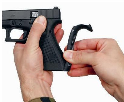
Abbildung 110 Entfernen/Befestigen Griffücken
