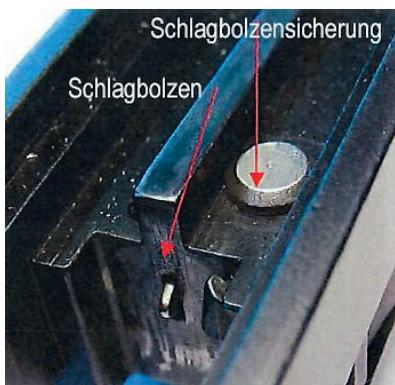
Abbildung 111 Sicherung rutscht in den Verschluss. Schlagbolzen kommt aus der Bohrung
