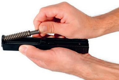
*Abbildung 28 Ausbau der Schliessfeder*
