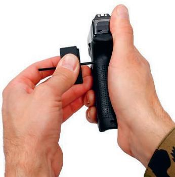
Abbildung 109 Entfernen/Befestigung Griffücken
