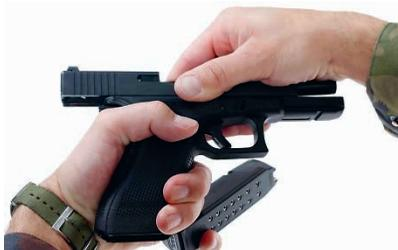
Abbildung 48 Verschlussstück zurückziehen und arretieren (Linkshänder)
