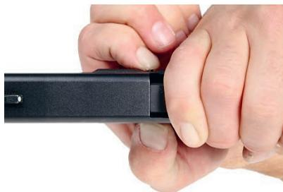
Abbildung 27 Verriegelungsschieber auf beiden Seiten nach unten drücken (Ansicht von oben).
