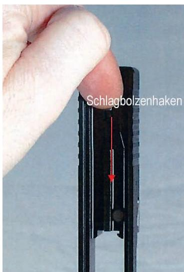
Abbildung 112 Druck auf den Schlagbolzenhaken in Laufrichtung
