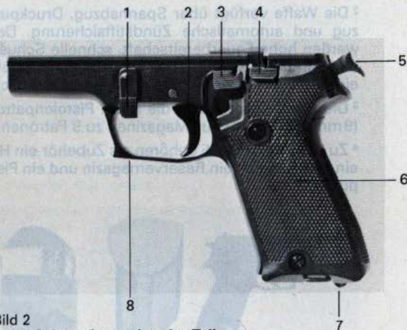
Bild 2 Beim Schuss feststehender Teil
